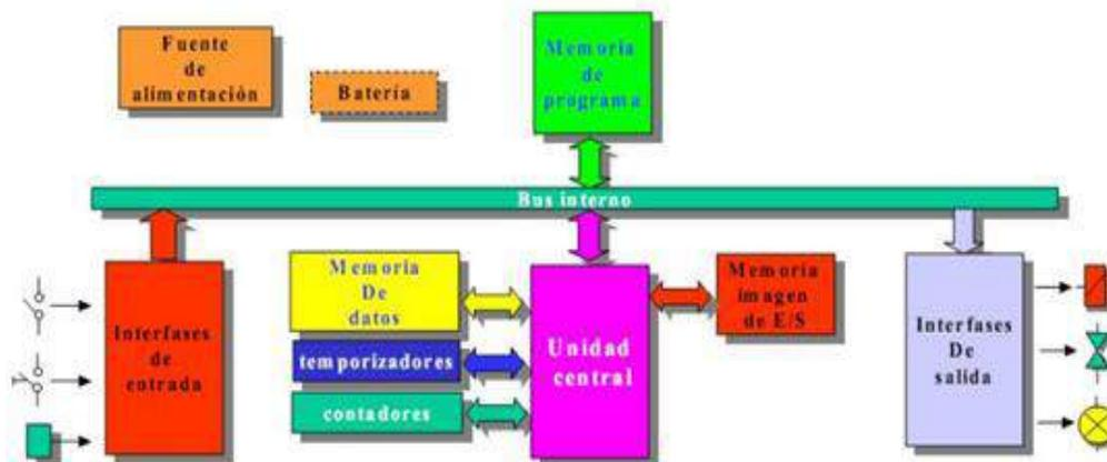
Fig. 14 Esquema de un sistema utilizando PLC
