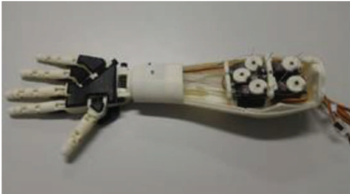
Figura 5 – Conexão e fixação dos servos motores na prótese InMoov
