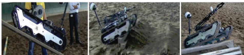
Figura 9 – Prueba de desplazamiento en pendientes (izquierda). Prueba de paso de obstáculos consecutivos (centro). Prueba de superación de obstáculos de gran tamaño (derecha).
