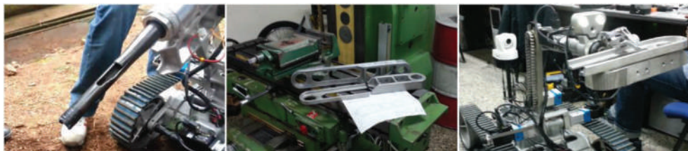
Figura 14 – Cuerpo del cañón destrozado por la explosión del mismo (izquierda). Eslabón del antebrazo mecanizado junto al eslabón fracturado (centro). Reemplazo del eslabón fracturado en el brazo manipulador (derecha).
