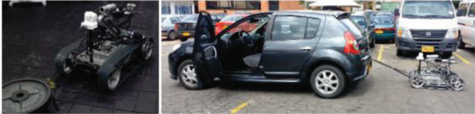
Figura 11 – Prueba de arrastre de peso muerto con alta fricción (izquierda). Prueba de arrastre de peso muerto con un vehículo (derecha).
