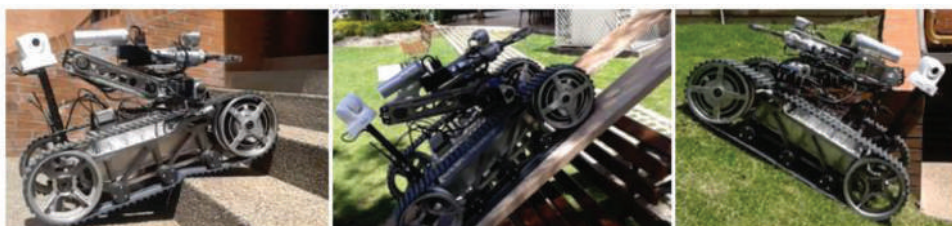
Figura 10 – Prueba subiendo escaleras (izquierda). Prueba de desplazamiento sobre pendientes (centro). Desplazamiento sobre terrenos inclinados (derecha).
