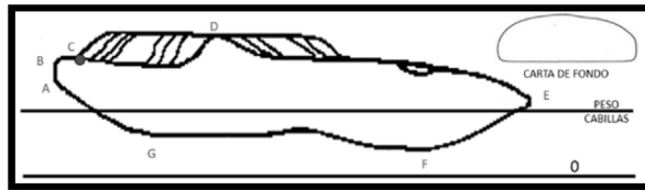
Figura 11 – Válvula Viajera dañada. DYNAPUMP.
