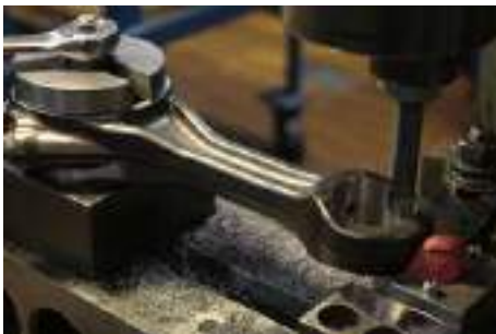
Figura 5. Mecanizado de una biela Fuente: connerengineering (2021)
