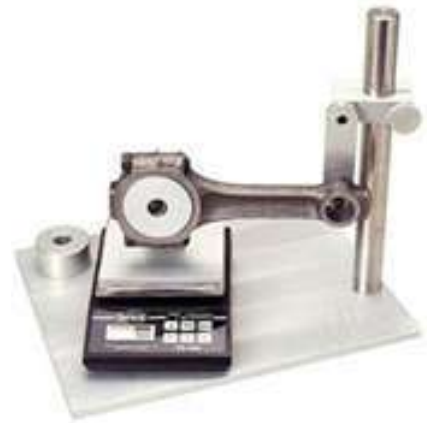
Figura 3. Pesaje de una biela Fuente: ebaying (2021)
