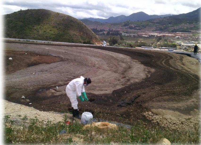
Figura 2 Recolección muestra en la Salida de la Planta de Tratamiento de Lixiviados RSDJ
