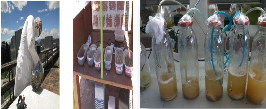
Figura 2 Esquema del diseño experimental aleatorizado de la fase de tratabilidad del efluente al 5 % (v/v) con el pool bacteriano y con el control, cada uno con tres réplicas
