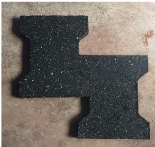
Figura 2. Prueba de elaboración de Adoquines de Caucho elaborados en la Planta de Reciclaje “RUBBERACTION”
