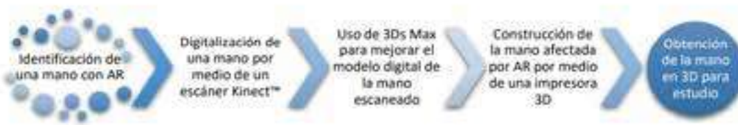
Figura 2. Esquema del proceso de prototipado de una mano mediante técnicas DIGITALIZACIÓN-DAO-PR.
