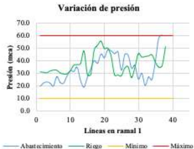
Figura 4. Variación de presiones en las redes de riego y abastecimiento.
