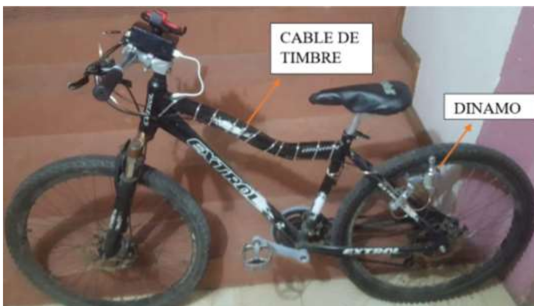
Ilustración 2 Implementación del prototipo en la bicicleta
