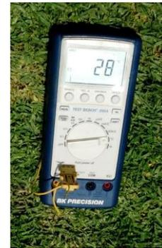
Figura 6. Multímetro Digital con Termopar tipo K.
