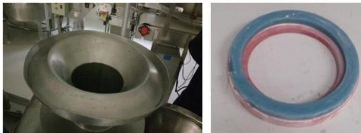
Ilustración 2. Cono y empaque dañados.
