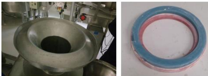
Ilustración 2. Cono y empaque dañados.
