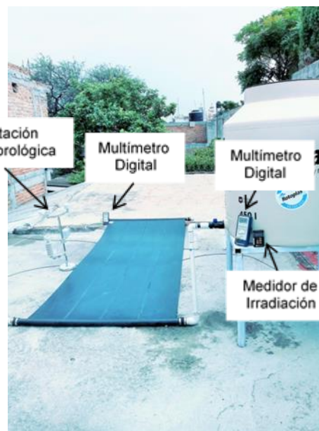
Figura 3. Instrumentación del Colector Solar de Placa Plana para Climatización del Agua de una Piscina.
