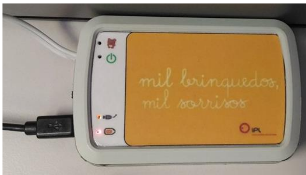
Figura 2 – Aspeto exterior do interruptor com fios.
