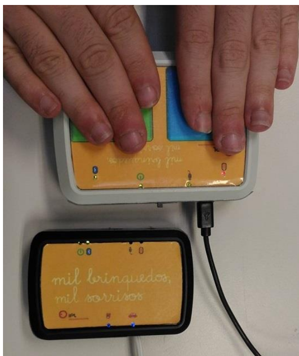
Figura 10 - Teste da comunicação entre o interruptor sem fios e o módulo recetor.
