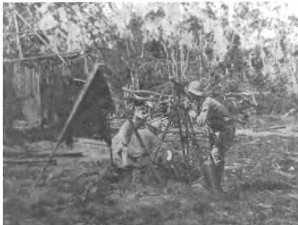
Los datos para el proyecto de dotación ejidal de 1930 se levantaron con un teodolito marca Breithaupt de un minuto de aproximación y estadía centesimal
